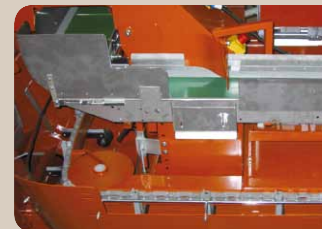
Arrivée du terreau sur le côté pour plantes en racines nues
