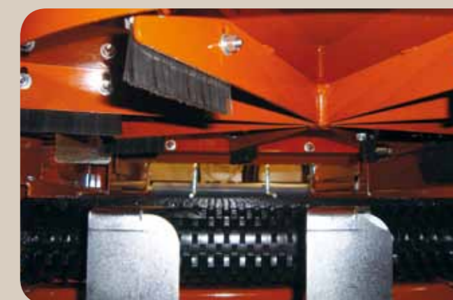
Vue du tapis d'évacuation et de la brosse rotative
