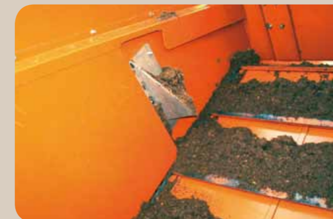
Vue intérieure Remontée du terreau par barres d'acier entraînées par chaînes.
