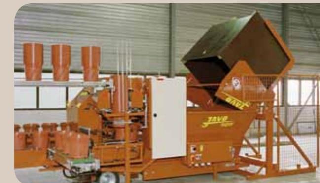
Basculeur hydraulique pour caisses et big bag Peut s'utiliser sur la plupart des machines Javo.
